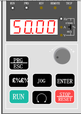
3-3-4 Ekran çalışma durumunda RUN yanar, inverter set frekansını gösterir and FWD devamlı yanar
