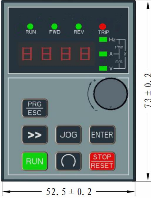
Şekil A5-1 S2R4GB~3004GB/35R5PB klavye montaj ölçüleri
