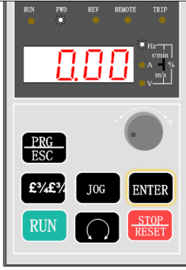
3-3-2 Ekran durma modunda. RUN yanmaz.FWD yavaş yanar söner.
