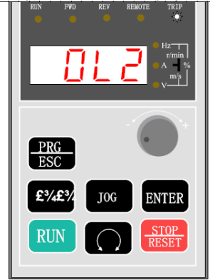
3-3-6 Ekran hata modunda. Hata kodu gösterir ve TRIP yanar.
