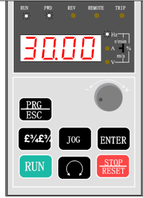
3-3-3 Ekran çalışma modunda RUN yanar.FWD hızlanırken hızlı yanıp söner.
